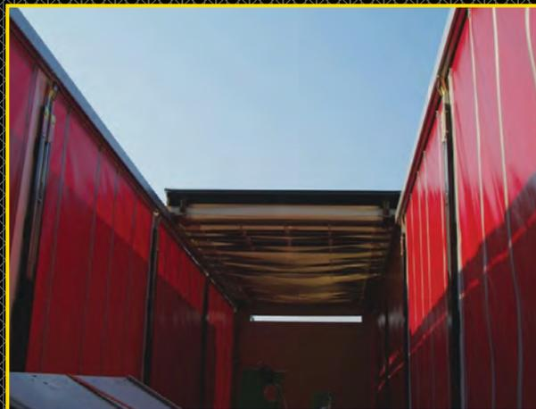
Die Protector® ROOF Version war als Alternative für die Aluminiumdächer entworfen und versorgte die gleichen Gesamtaufbaustärken dank die axiale Stahldrahtverstärkung, aber mit unleugbaren Vorteilen, d.h. verringertes Gewicht, wirkungsvollerer Schutz gegen Einbruch von Illegalen, das Dach kann geöffnet werden, einfachere Schadenreparatur (PVC-Oberfläche), Durchsichtigkeit und die wettbewerbsfähige Preisbestimmung.
