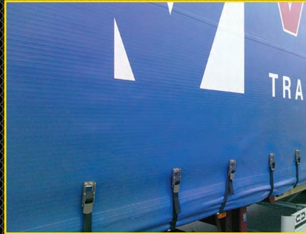
Die Protector PRO Version wird direkt zum Planenstoff durch Hitzeschweißen installiert. Dieses Schweißen kann nur auf neue PVC Gewebe erfolgt werden.
